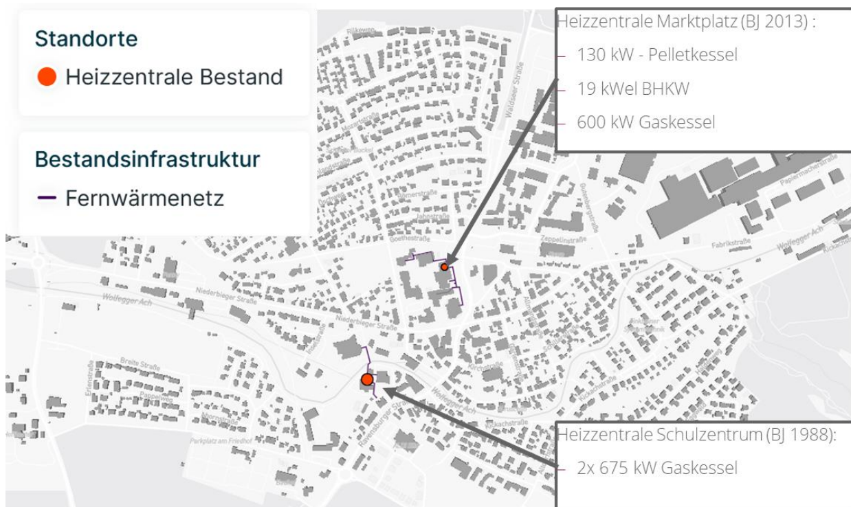
Abbildung 2-23: Wärmeerzeugungsanlagen, die in ein Nahwärmenetz einspeisen
